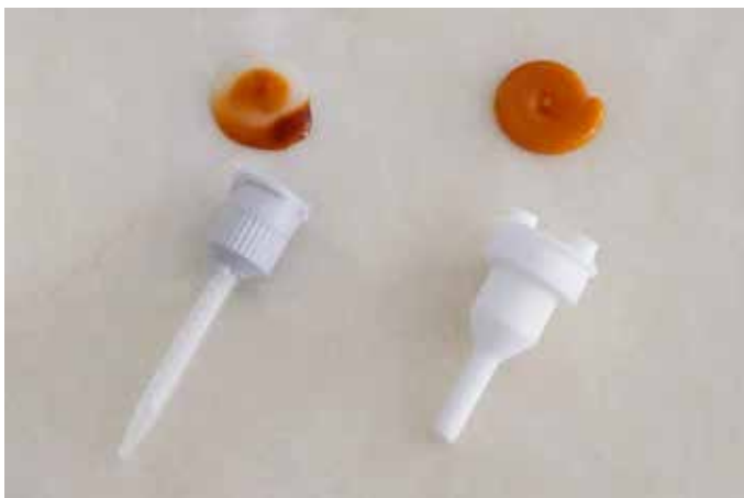
Comparaison : Résultat du mélange : mélange statique (à gauche), résultat du mélange : mélange dynamique (à droite)
