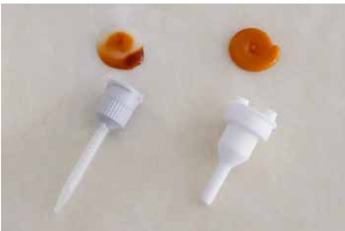
Vergleich: Mischergebnis statische Mischung (links), dynamische Mischung (rechts)
