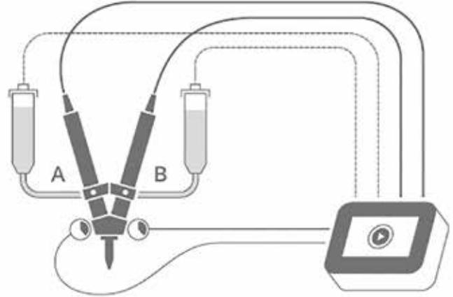
Liquides non autonivelants, viscosité moyenne à élevée, y compris technologie des capteurs et mise sous pression
