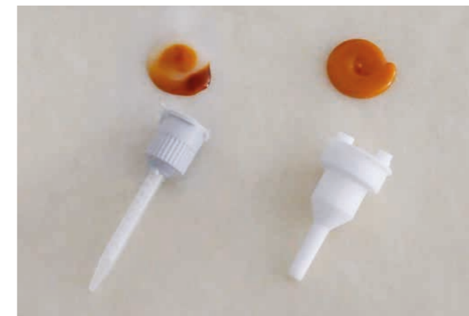
Confronto: risultato della miscelazione statica (sinistra) e dinamica (destra)
