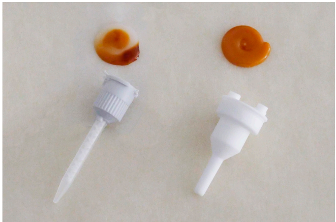
Comparación: resultado del mezclado estático (izquierda), mezclado dinámico (derecha)
