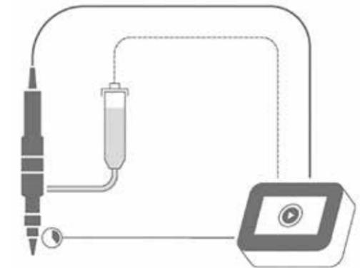
Liquide non autonivelant, viscosité moyenne à élevée, y compris mise sous pression
