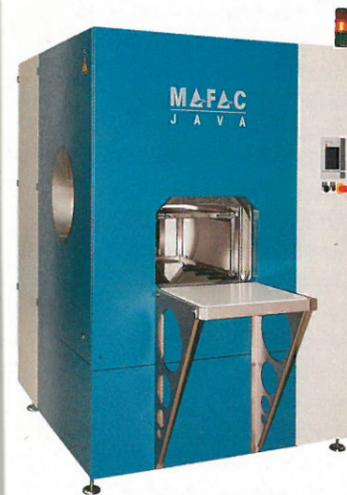
Als Antwort auf die steigenden Anforderungen des Downsizing-Trends in der Industrie hat Mafac eine neue Maschinen- generation zur wässrigen Reinigung von Präzisionsbauteilen entwickelt. Dank ihrer neuen kinematischen Verfahrenstechnologie werden Kleinstbauteile **effizient** und hochwertig gereinigt. Das neue Verfahren ist serienmä-
