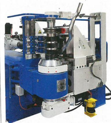
'Keep it simple!' Diesem Ingenieurs-Grundsatz folgend hat der Rohrbiegemaschinenhersteller Schwarze-Robitec das neue Schnellspannsystem 'Quick Tool Unlock' für Rohrbiegemaschinen entwickelt. Es ermöglicht laut Hersteller einen werkzeuglosen und zügigen Wechsel der Biegeschablonen und reduziert Rüstzeiten somit spürbar. Das Schnellspannsystem besteht aus einer geteilten Sonderzugstange mit Spannhebel sowie einer Schwenkvorrichtung. Während bei
